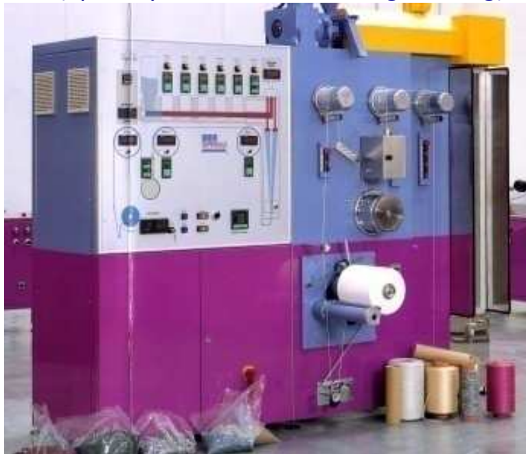
Pilote de filage par voie fondue (Spinboy I de Busschaert Engineering)
