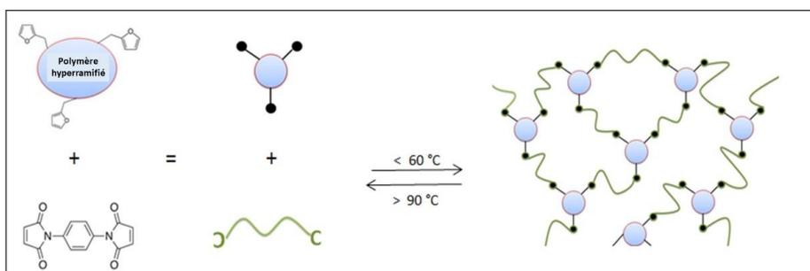
Figure 1 : Exemple d'élaboration d'un réseau macromoléculaire tridimensionnel réversible
