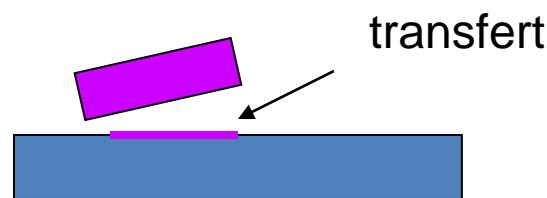
Rôle primordial du **3 corps** : peut augmenter ou diminuer la friction et/ou l'usure
