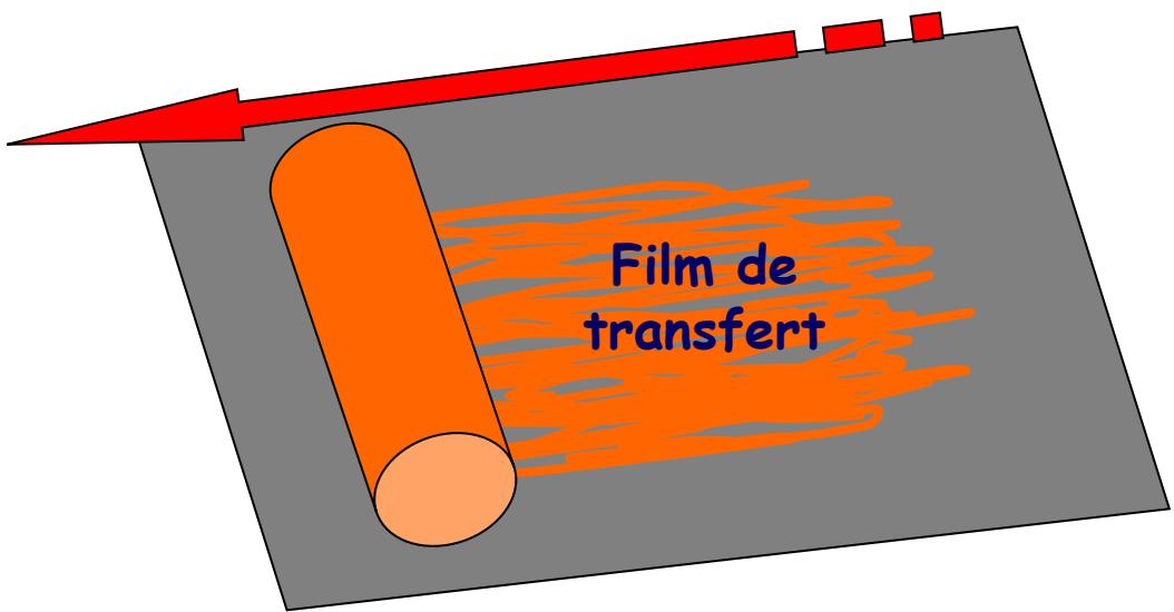
**Friction** d'un polymère sur un substrat : susceptible de générer un film de **transfert**
