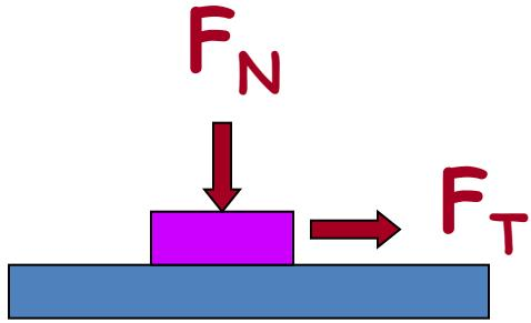
$F_T$  : force tangentielle nécessaire pour déplacer les 2 matériaux en contact sous une force normale  $F_N$
