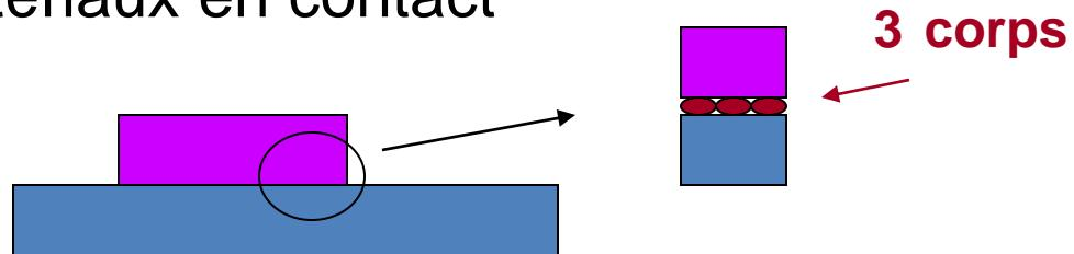
+ **troisième corps** (particules d'usure, film de transfert...), dont les propriétés peuvent être différentes de celles des matériaux d'origine
