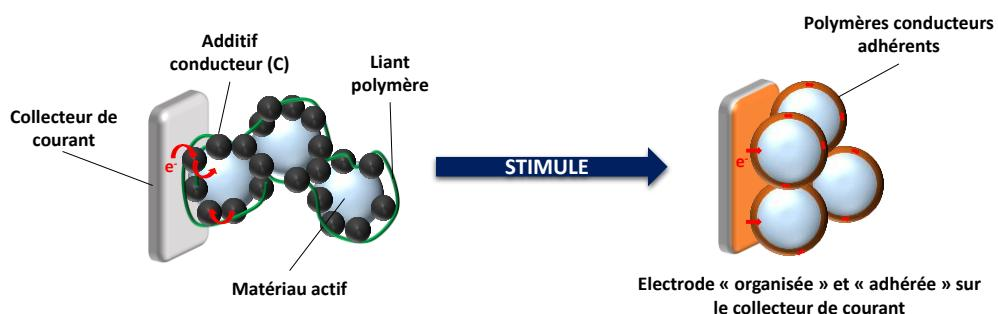
Plus précisément, la synthèse de polymères conducteurs disposant de fonctions de greffage sera menée dans un premier temps. Par la suite, ces entités seront greffées sur des matériaux d'électrodes dans le but d'améliorer leurs propriétés de conduction et de tenue mécanique. A plus longue échéance, la réalisation d'une batterie complète sans additif conducteur sera envisagée.
