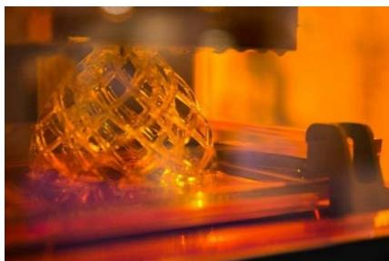
(Image : Procédé de fabrication additive par photopolymerization)
